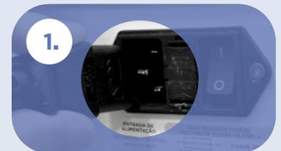
1. Conecte o cabo de alimentação elétrica na parte traseira do Andrômeda® e na rede elétrica. Certifique-se que a área em torno do cabo de alimentação esteja livre.
