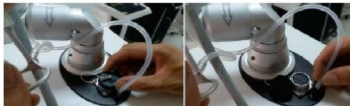
Esquema de instalação de tubo de exaustão de fumaça.
